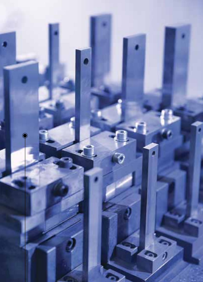
МАТРИЦЫ ДЛЯ ХОЛОДНОГО ПРЕССОВАНИЯ ИЗГОТОВЛИВАЮТСЯ ИЗ ВЫСОКОЛЕГИРОВАННЫХ СТАЛЕЙ С ВЫСОКОЙ ТОЧНОСТЬЮ
